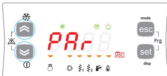
La pression des deux touches permet d'entrer dans le menu avec la liste des rubriques. A l'aide des touches haut et bas sélectionner la rubrique PAR.
