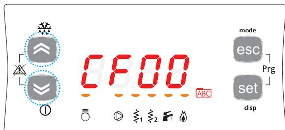
Le paramètre CF00 s'affiche (configuration d'usine par défaut). Pour faire défiler les différents paramètres il suffit d'appuyer sur la touche haut pour passer au paramètre suivant (dans ce cas CF01) ou la touche bas pour passer au paramètre précédent (dans ce cas CF47).
