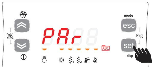
Appuyer sur les touches up et down pour sélectionner le sous-menu Par.
