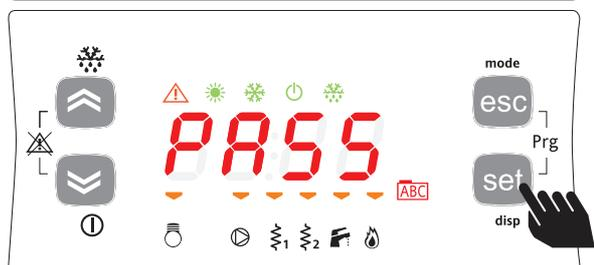
Pour entrer dans la rubrique PASS appuyer sur la touche set. Configurer le mot de passe (installateur ou constructeur) appuyer sur set et sortir.
